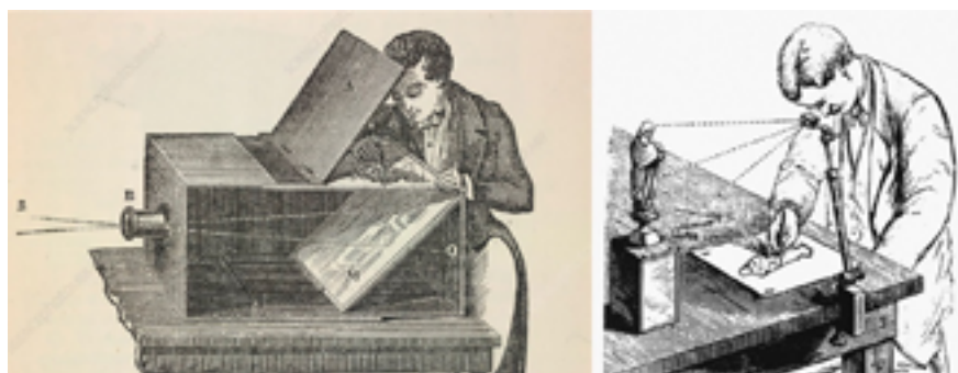
Fig. 3. Câmara Obscura (esq.). Câmara Lúcida (dir.). Imagens: Autores datas desconhecidos.
