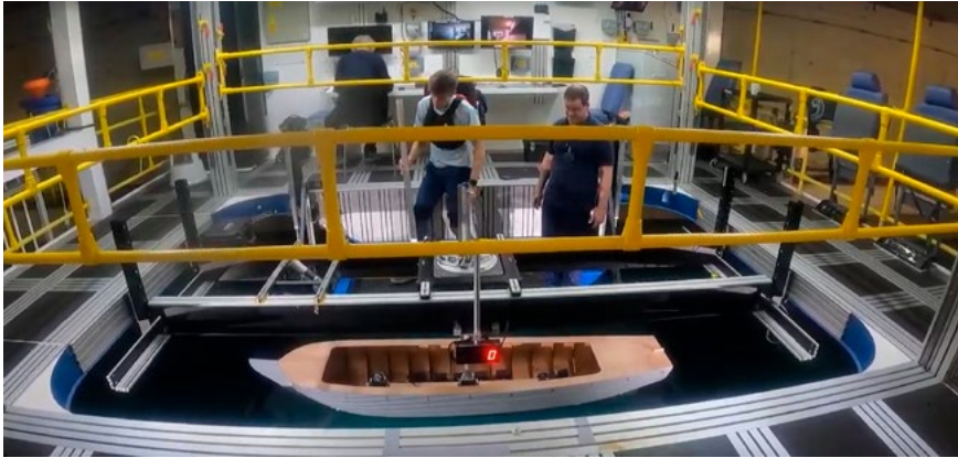
Fig. 5. Modelo a escala del casco del USS Somers durante los experimentos de ingeniería náutica inversa en el canal de pruebas hidrodinámicas de la Universidad de Southampton, Reino Unido (Jorge M. Herrera, 2023)
