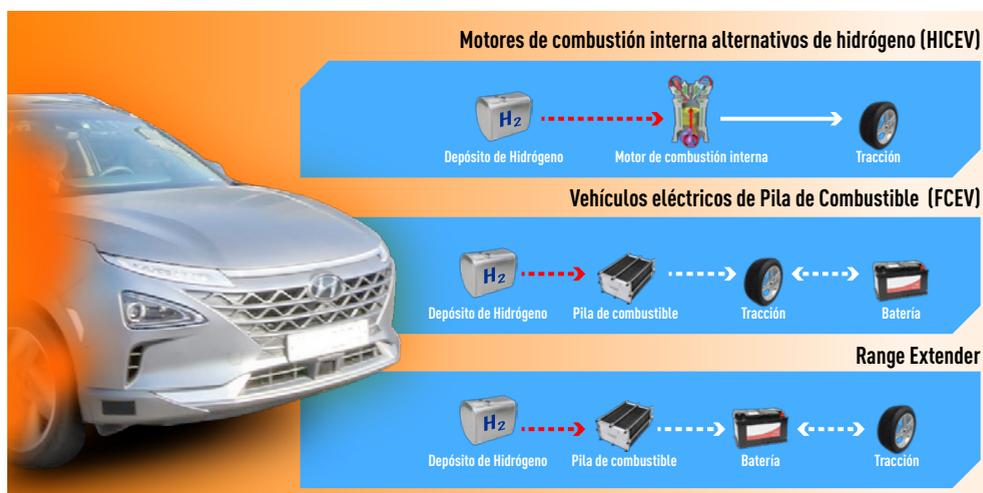
Figura 16: Tipología de vehículos de hidrógeno. Fuente: Adaptado de Centro Nacional del Hidrógeno, [33].
