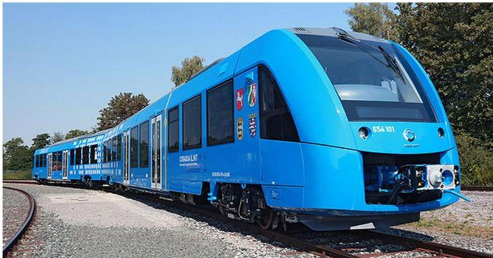
Figura 24: Tren regional eléctrico de pila de combustible Coradia Iltint. Fuente: Unimedien, Alstom [39].
