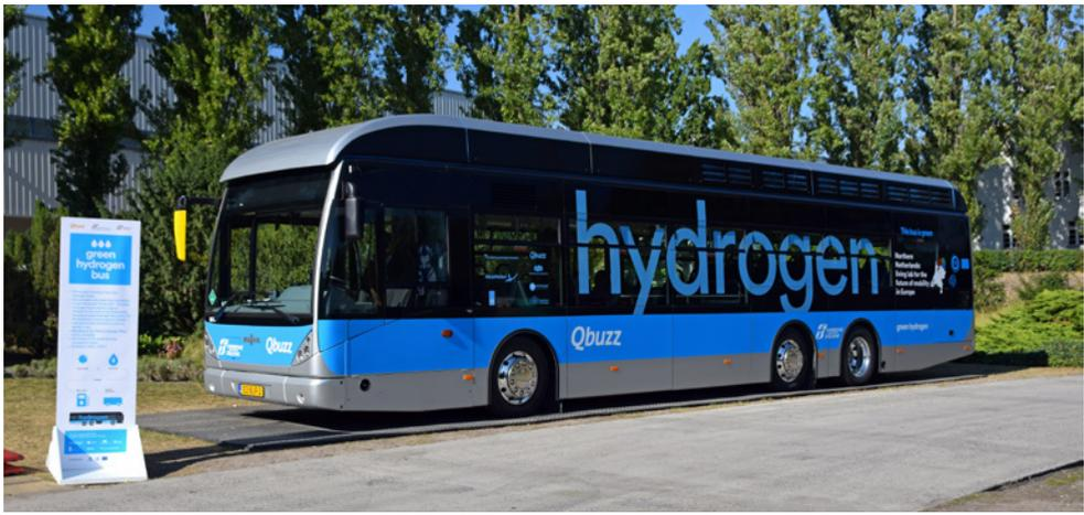
Figura 20: Autobús eléctrico de pila de combustible. Fuente: Paceman / Shutterstock.com.
