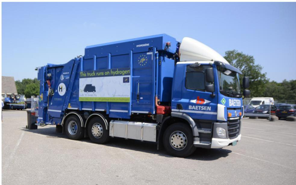
Figura 21: Camión de basura eléctrico de pila de combustible. Fuente: Fuell Cells work [37].
