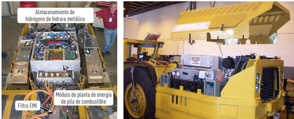
Figura 26: Conversión de maquinaria minera subterránea diésel a hidrógeno. Fuente: Fuelcell-Hybrid Mine Loader [41].
